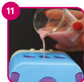
11 Wlewanie masy akrylowej do puszk polimerizacyjnej
