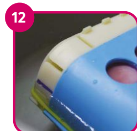
12 Puszka w garnku polimerizacyjnym, woda nie zakrywa kanałów wlewowych
